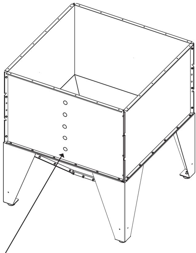
**NB .:** Stanzvorrichtungen für die Unterbringung des Sensors für den minimalen Brennstoffstand Art.Nr.: EN4210.00.01
