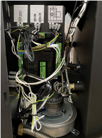
Hauptplatine mit Anschluss des Pufferfühlers (BHW Sensor)
