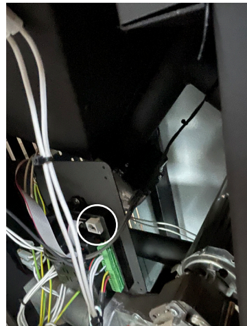
Hauptplatine mit RS232 Schnittstelle für WLAN-Modul
