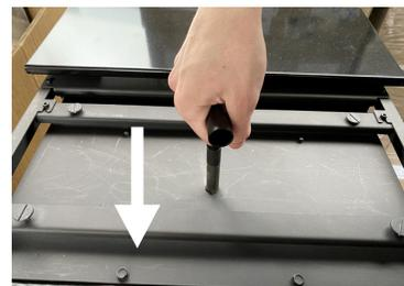
Schrauben Sie nach dem Abnehmen des oberen Keramikteiles den T-förmigen Griff auf den Griffhalter. Bewegen Sie dann das Reinigungssystem, indem Sie den Griff mindestens zehnmals abwechselnd nach oben ziehen.
