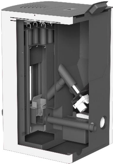
Um sicherzustellen, dass Ihr Pelletofen immer mit einem hohen Wirkungsgrad arbeitet, sollten Sie alle 300 Kg verbrannter Pellets die manuelle Reinigung der Turbulatoren durchführen.
